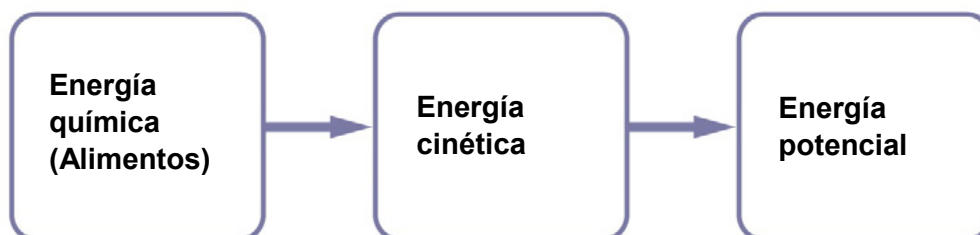
Fig. 5: Cadena simplificada de conversión de energía cuando se conduce cuesta arriba en una bicicleta.
